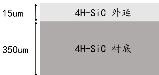
图6： 4H-SiC 衬底和外延示意图
