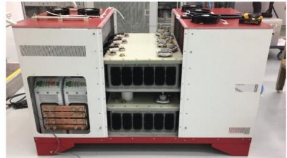
(b) 12.4 kV 光伏并网逆变器
