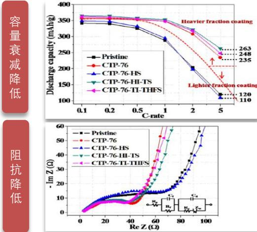
图：中高温材料在放电容量上优于低温材料
