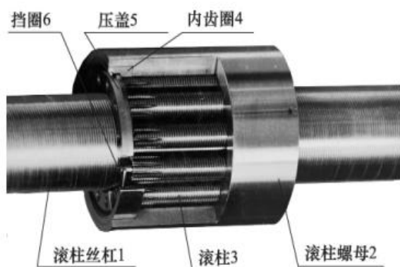
图 32：行星滚柱丝杠构成
