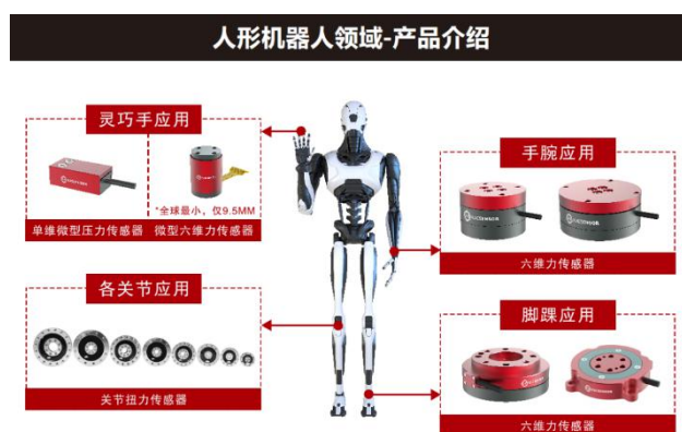
图 17：鑫精诚传感器在人形机器人的应用
