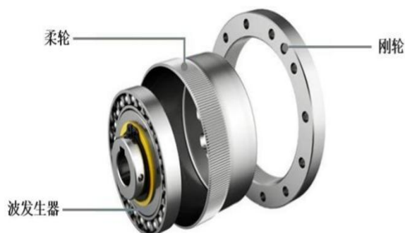
图 26：谐波减速器结构图
