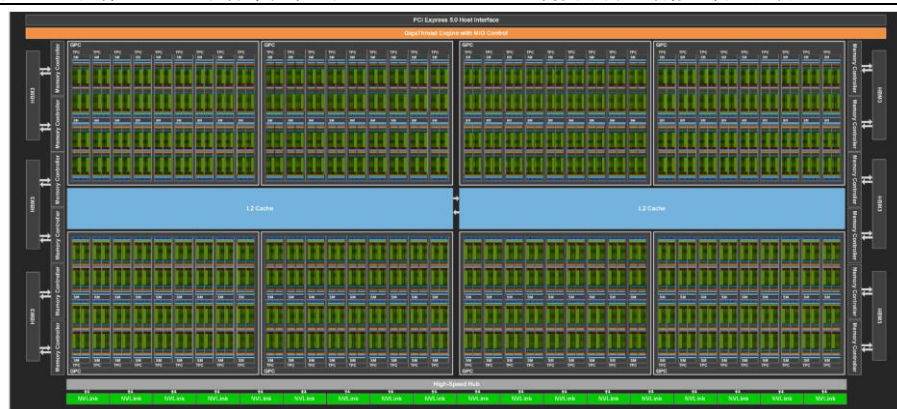
图 30：英伟达 H100 硬件架构示意图，大量 CUDA Core 需要跟片上缓存、管口配合
